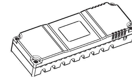
Die LS6-Box-6(2) Regelklemmleiste wird mit Wechselstrom betrieben. Dabei wird die Spannungsversorgung zu den einzelnen angeschlossenen Geräten von der LS6-Box-6(2) gewährleistet. Der Vorteil hierbei ist, dass die Spannungsversorgung und der Datenaustausch über ein zweiadriges Kabel erfolgt. Es können bis zu 6 Geräte gleichzeitig an der Regelklemmleiste betrieben werden.
